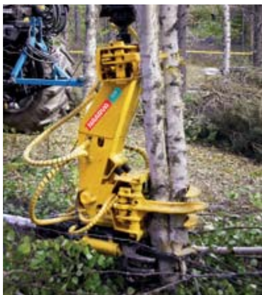
Naarva E20 med kraftig Ø 23 cm giljotin och med hög övre grip.
