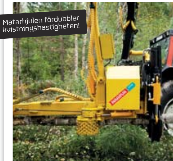
Den hjulmatade stegmataren S25R har fyra olika kvistningshastigheter och -krafter.
